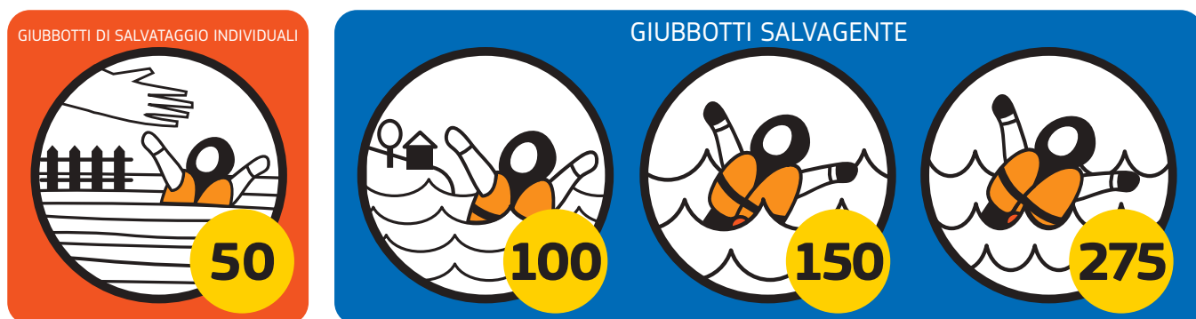
VI-1. Livelli di galleggiamento per giubbotto di salvataggio individuale (adattamento da RNLI).
